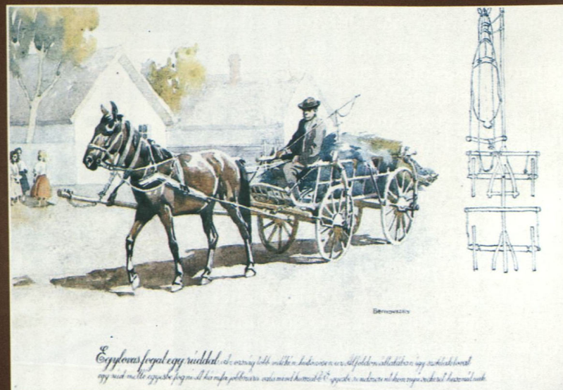
Egylovas fogat presupune un singur cal înhamat la o caruta de doi cai, de regula la stânga oistei. Observati ca frânarea si oprirea se face cu gâtar atasat la opritoarea de la oiste, în cazul de fata calul poarta doua gâtare, unul pentru oprire - frânare, iar al doilea pentru a tine oistea cât mai aproape de
