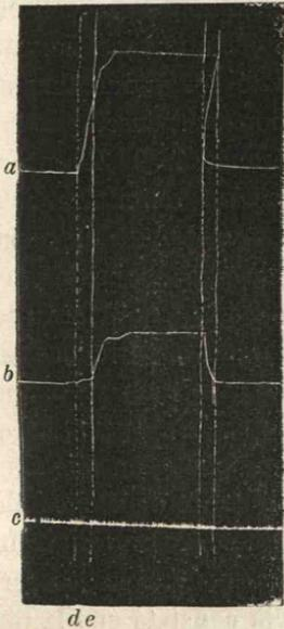
Fig. 3. — *a*, réaction buccale; — *b*, réaction de la main; — *c*, tracé du diapason; — *d, e*, retard de la réaction de la main = 0",14.
