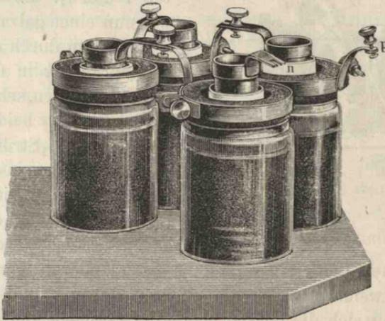
und in diese Flüssigkeit taucht ein Cylinder aus Zink. Jeder Zinkcylinder ist durch einen metallischen Bügel mit dem Kohlencylinder des nächsten Glases verbunden, der letzte Zinkcylinder *n* mit der einen Platinplatte, der erste Kohlencylinder *p* mit der an-
