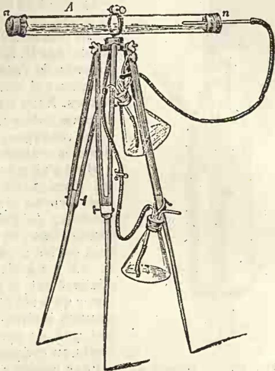
Fig. 28. — Appareil de Hesse pour compter et cultiver les germes de l'air. — *a*, membrane de caoutchouc fermant l'une des extrémités du tube A qui contient la gélatine; *n*, tube de verre servant à l'aspiration de l'air.
