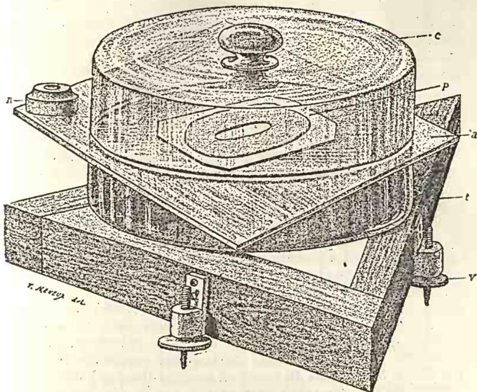
Fig. 26. — Appareil de Koch destiné à faire des cultures d'isolement sur des plaques de verre. — *t*, trépied, muni de vis calantes *v*, destiné à soutenir la plaque de verre *a* dans une direction horizontale; *n*, niveau à bulle d'air; *p*, plaque sur laquelle la gélatine se solidifie; *c*, cloche protectrice.
