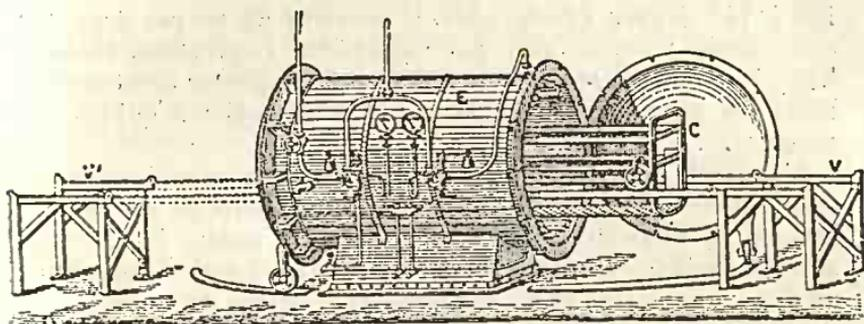
Fig. 44. — Étuve fixe de MM. Geneste, Herscher et C<sup>o</sup>, pour la désinfection du linge et de la literie. — E, corps de l'étuve sur lequel on voit les tubes abducteurs pour la vapeur, les manomètres, les purgeurs, etc.; la porte de droite est ouverte; C, chariot mobile sur lequel on dispose les objets à désinfecter; il roule sur les rails mobiles *v* et *v'* pour faciliter l'introduction et la sortie des objets.
