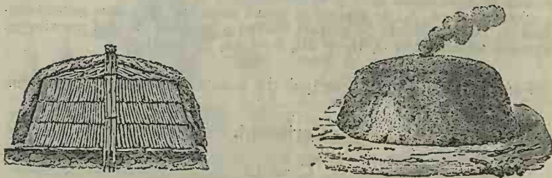
Fig. 62 și 63. Aședarea și arderea lemnelor pentru fabricarea cărbunelui.
