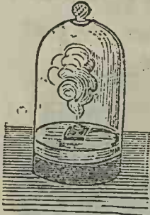
Fig. 46. Izolarea azotului prin fosfor.
