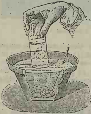
Fig. 3. Prepararea hidrogenului prin sodiu.
