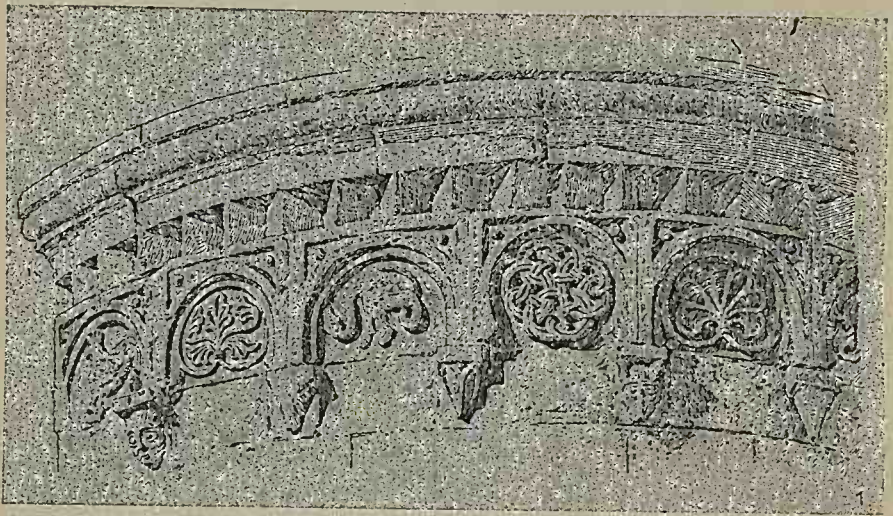
Abb. 73. Rundbogenfries an der südlichen Seitenapsis der Kirche in Brenz. (Aus „Paulus, Die Kunst- und Altertumsdenkmale im Königreich Württemberg“.)
