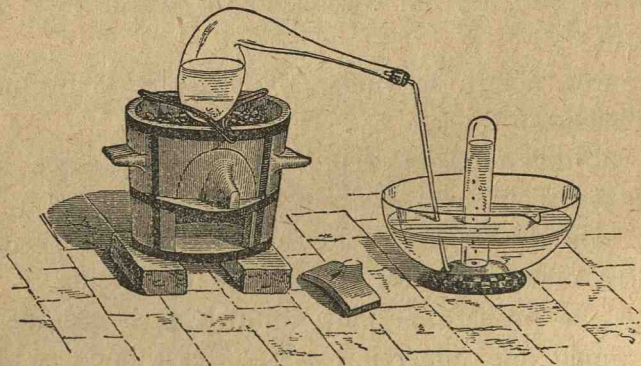
Fig. 29. Prepararea oxigenului din cloratul de potasiu.
