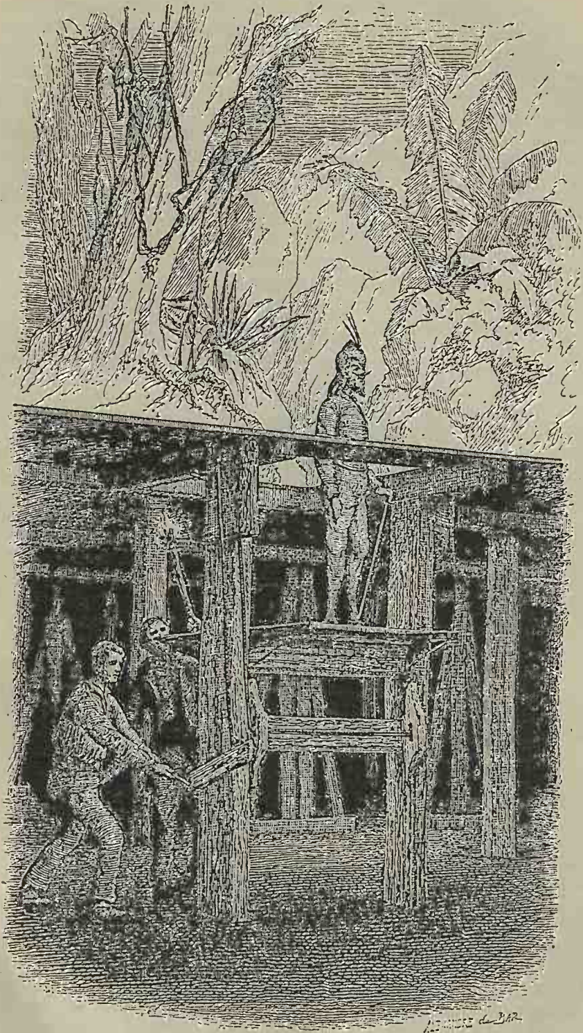
PLANCHE XXXV. — Jeu et mécanisme d'une trappe par laquelle un personnage paraît instantanément sur la scène.
