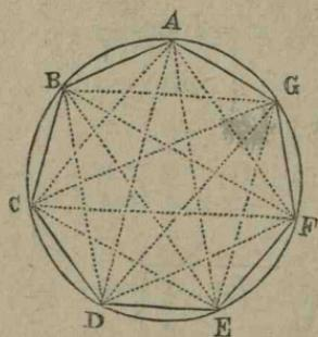
in siepte parti egale. Deca unim punctele de divisiune din unul in unul seu din siesse in siesse, obtinem un poligon regulat inscris de siepte laturi, ABCDEFG ; in figura acest poligon este insemnat cu trasatura continua. Deca am uni
