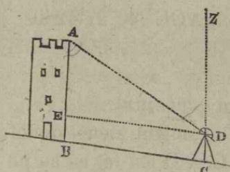
Asiediäm un instrument de mesurat anghiurile in D, si apoi insemnäm pe turn un punct E astfel că EB se fie egal cu DC. Mesuräm pe urma anghiul ADE, precum si anghiul ADZ, pe care 'lu face drepta AD cu verticala DZ; mesuräm in fine basea  $BC=ED$ . Trianghiul AED, in care cunoscem laturea ED si anghiurile ADE si EAD= $ADZ$ , ne va da pe  $AE^*$ ; adaogind la acesta quantitate  $EB=DC=h$ , inaltimea instrumentului, vom avé inaltimea AB a turnului.
