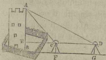
ful turnului cu directia orizontale CE. Mutäm apoi instrumentul in D, tot pe linia EC, si mesuräm anghiul ADE; in fine mesuräm si pe  $FG=CD$ . In trianghiul
