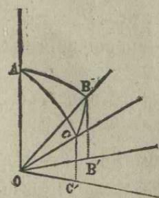
Un observator  $O$  măsura anghiul  $BOC$  al radiei visuale duse la doue obiecte  $B$  si  $C$ , anghiul  $BOC$  nefind în un plan orizontal. În aplicatiuni inse este mai tot-de-una necesară a se cunoaște nu ensusi anghiul  $BOC$ , ci proiecția  $B'OC'$  a acestui anghiu pe un plan orizontal. Aceasta proiecție se numește *anghiul redus la orizont*.
