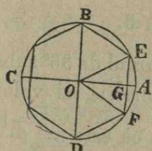
Latura EF a unui exagon regulat inscris subintinde un arc EAF de  $60^\circ$ ; radia OA, perpendiculara pe acesta latura, imparte arcul EAF in doue parti EA si AF, fie-care de cîte  $30^\circ$ ; asemenea EG=GF. Inse  $EF=OE=1$ ; prin urmare
