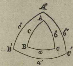
anghiul opus din trianghiul polar ; astfel :  $a+A'=180^\circ$ ,  $b+B'=180^\circ$ ,  $c+C'=180^\circ$ ; b) fiecare anghiu al trianghiului considerat ABC este egal cu una semicircumferinta minus laturea opusa din trianghiul polar ; astfel :  $A+a'=180^\circ$ ,  $B+b'=180^\circ$ ,  $C+c'=180^\circ$ .
