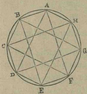
Deca unim punctele de divisiune *din unul in unul* seu *din siepte in siepte*, obtinem un octagon regulat, ABCDEFGH, care in figura este insemnat cu trasatura continua. Unind punctele de divisiune *din trei in trei* seu *din cinci in cinci*, am obtine un
