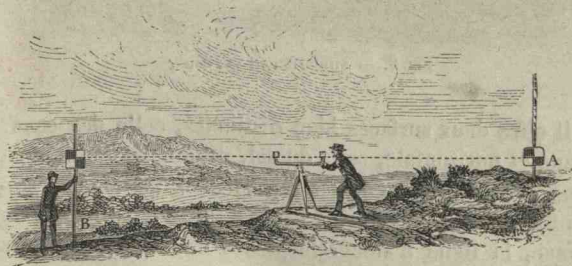
Fig. 8. — Opération du nivellement.
