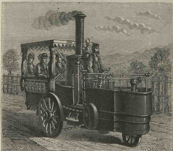
Fig. 124. — Locomotive routière à voyageurs.
