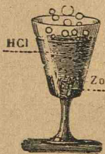
Fig. 31 — Pahar cu bucățele de zinc în dizoluțiune de acid clorhidric.
