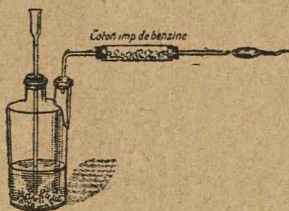
Fig. 102. — Flacăra hidrogenului trecut prin benzină este strălucitoare.
