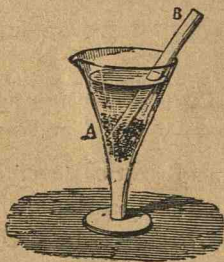
Fig. 62.—Lamă de cupru B într'un pahar cu acid azotic fumant A.
