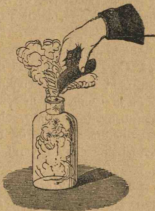
Fig. 40. — Pulbere de antimoniu ardând în clor.
