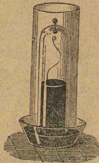
Fig. 59. — Eudiometru pus într'un vas cu apă fiertă.
