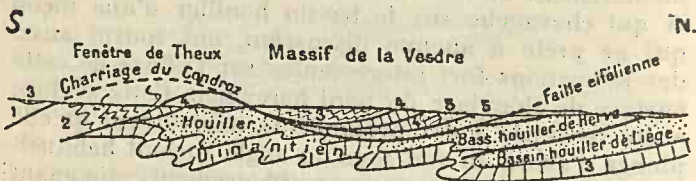
FIG. 5. — Coupe de la fenêtre de Theux (d'après Fourmarier). 1, Cambrien ; 2, Silurien ; 3, Dévonien ; 4, Dinantien ; 5, Westphalien.
