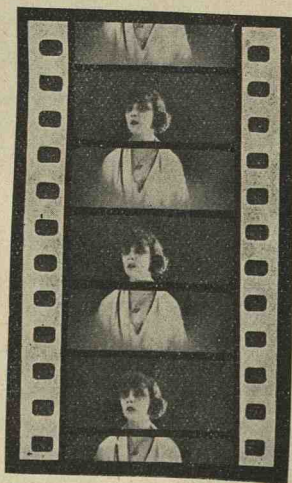
Fig. 21. — Image décadée par suite d'une collure défectueuse
