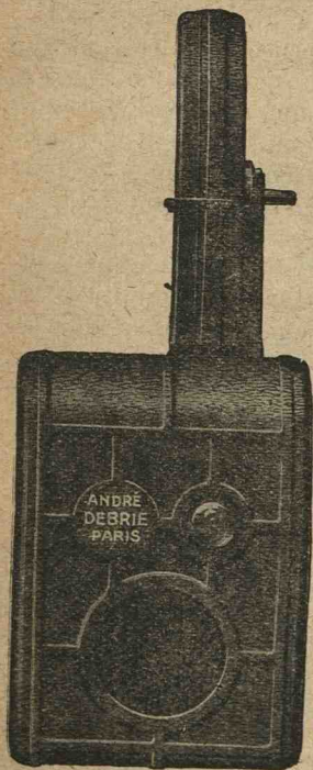
Fig. 66. — Position du Jacky pendant la projection
